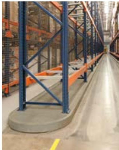
En la entrada de los pasillos con guiado mecánico, se colocan perfiles de entrada con embocaduras reforzadas para facilitar el centrado de las máquinas.
