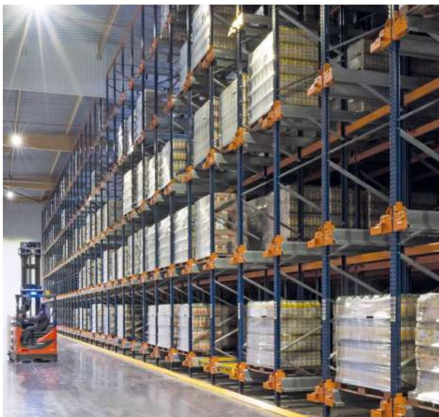
ben colocar el Pallet Shuttle en el canal correspondiente y depositar los palets en la primera posición de las estanterías. De este modo, se han optimizado los movimientos de los operarios porque, en realidad, es la carga la que se desplaza sola hasta su ubicación.
