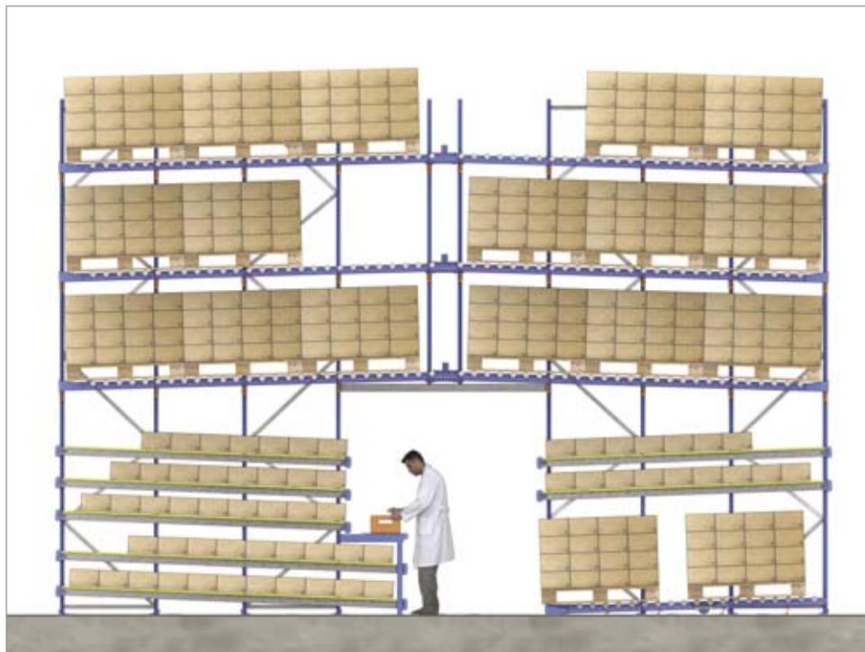
Este dibujo representa un almacén de picking dinámico en altura, con una pasarela intermedia. En uno de los lados se hace picking sobre paletas depositadas en estanterías de paletización.
