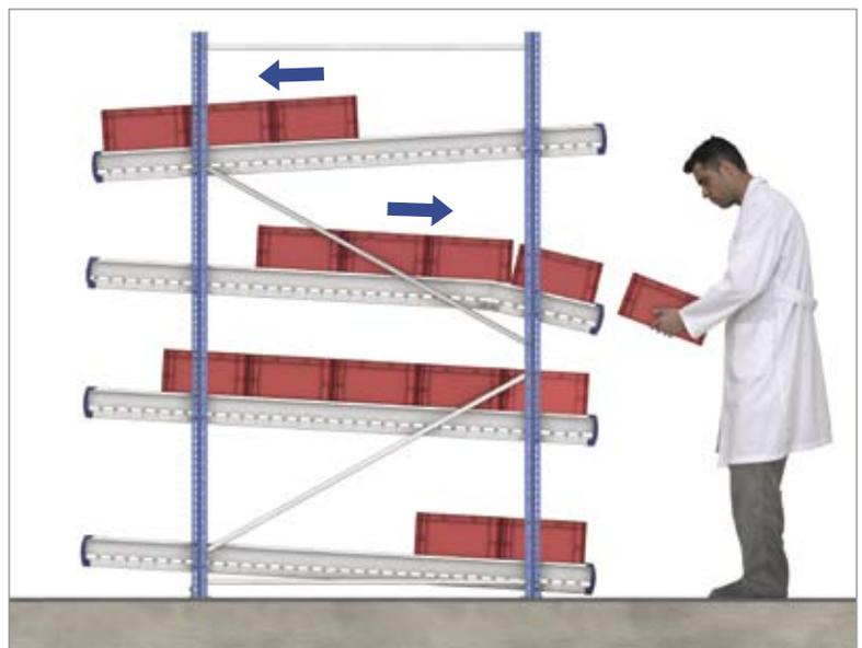
Aquí se combina el picking de cajas en niveles de picking dinámico con el picking sobre paletas en el nivel inferior, también sobre planos inclinados con rodillos.
