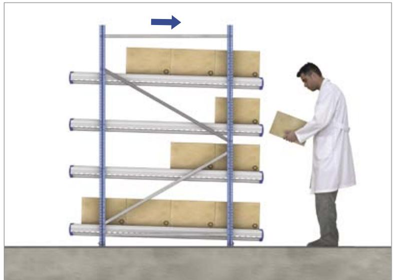
En esta imagen vemos una solución con retorno de cajas vacías por el nivel superior. Es una solución frecuente en cadenas de montaje.
