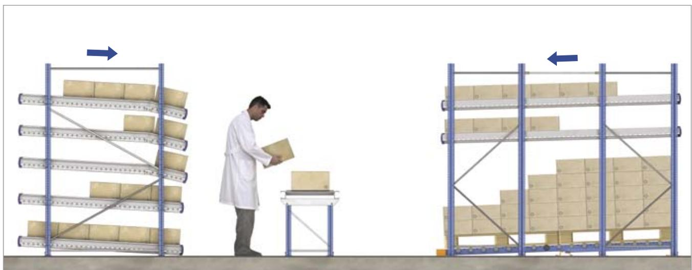
Sobre las estanterías de picking dinámico, se disponen niveles para almacenar paletas con reserva de los productos colocados en la parte inferior.
