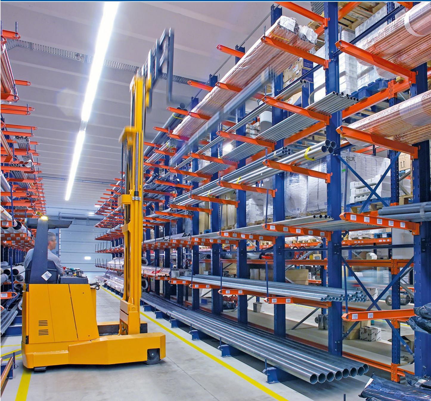
Mecalux ha desarrollado distintos perfiles metálicos laminados en caliente para conformar el sistema de racks cantilever, con grosores y medidas que abarcan todas las exigencias del mercado: columnas y brazos para cargas ligeras, medias o pesadas. Para elegir el sistema más adecuado, además del peso de la carga, deben considerarse también
