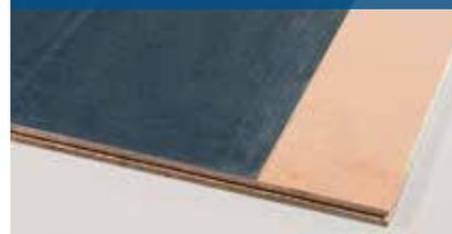
El piso de tablero aglomerado de madera puede recubrirse con chapa galvanizada de 1,5 mm de espesor cuando sobre el entrepiso vaya a circular algún tipo de transpallet o carro pesado y quiera evitarse el desgaste del tablero, así como minimizar el ruido del desplazamiento.
