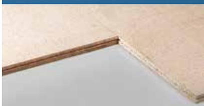
Formado por tableros de madera aglomerada de 30 mm de espesor que se unen entre sí mediante empalmes o por encaje mediante machihembrados. Una vez colocados los tableros, el piso presenta una superficie lisa sin acabado superficial. Una variante es el suelo con tablero ignífugo, tratado contra la propagación del fuego y con clasificación M1.
