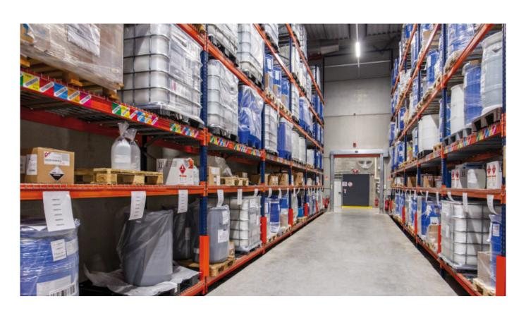
El almacén se compone de estanterías para palets de 10 m de altura con una capacidad de almacenaje total de 8.250 palets. Los niveles están formados por estantes de malla electrosoldada, que garantiza una mayor estabilidad de las cargas y evita la caída accidental de los materiales. "El presupuesto nos pareció correcto, si bien lo que nos llamó la atención de esta solución fue la capacidad que nos proporcionaba", destaca el director general.
