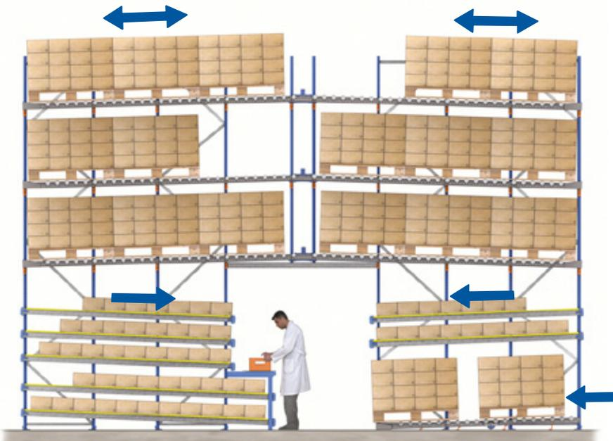
**3** Niveles dinámicos con entrada y salida por ambos lados, que abastecen los niveles inferiores de picking. Aquí se combina el picking sobre pallets y el picking en el interior de las cajas. Las cajas se extraen de los pallets y se introducen en niveles dinámicos para cajas.
