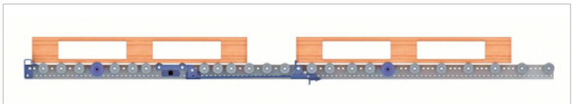
Detalle donde se aprecia la holgura necesaria entre dos pallets para que actúe el retenedor.
