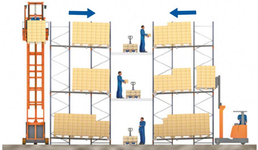
**4** Puestos de picking sobre pallets en varias plantas, alimentados con pallets que provienen del depósito de reserva. En esta solución el medio de elevación es una carretilla torre o una retráctil y el preparador de pedidos deposita la mercadería sobre un carro o un transpallet.
