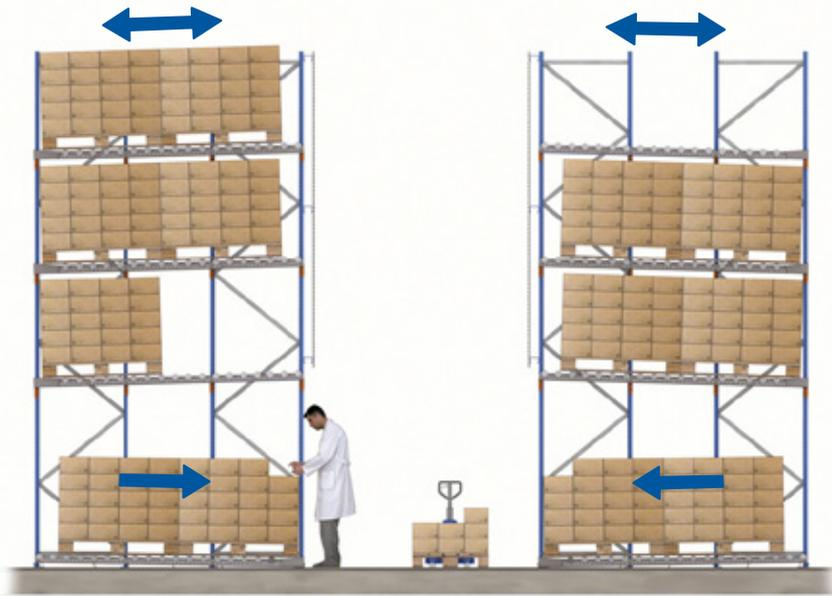
**2** Niveles dinámicos con entrada y salida por el mismo pasillo, que alimentan niveles de picking colocados en su parte inferior. La parte superior de los racks del lado del pasillo de picking ha de ir protegida con mallas anticaída. Al igual que en los anteriores dibujos, los pallets de los niveles superiores se introducen en los inferiores.
