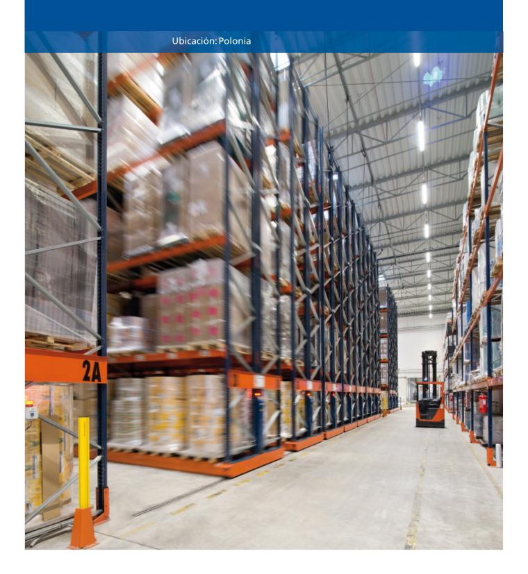
Mecalux ha instalado estanterías sobre bases móviles Movirack en el almacén que Refresco, compañía embotelladora de refrescos, posee en la ciudad de Mogielnica (Polonia). Este es un sistema de almacenaje por compactación que suprime el número de pasillos, a la vez que ofrece una óptima capacidad de almacenaje, ideal para obtener una mayor capacidad de almacenaje y, al mismo tiempo, abastecer producción con rapidez.
