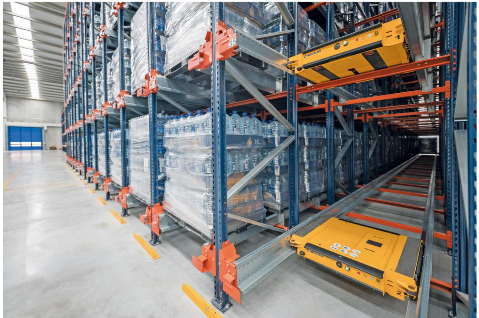
una superficie aproximada de 780 m<sup>2</sup> y posee una capacidad de almacenaje de 2.850 palets de 800 x 1.200 mm con un peso máximo unitario de 1.000 kg. Con una altura de 10 m, las estanterías cuentan con cinco niveles y un total de 95 canales de almacenaje. Cada uno de ellos con capacidad para 30 palets en profundidad. El sistema Pallet Shuttle, además de maximizar el
