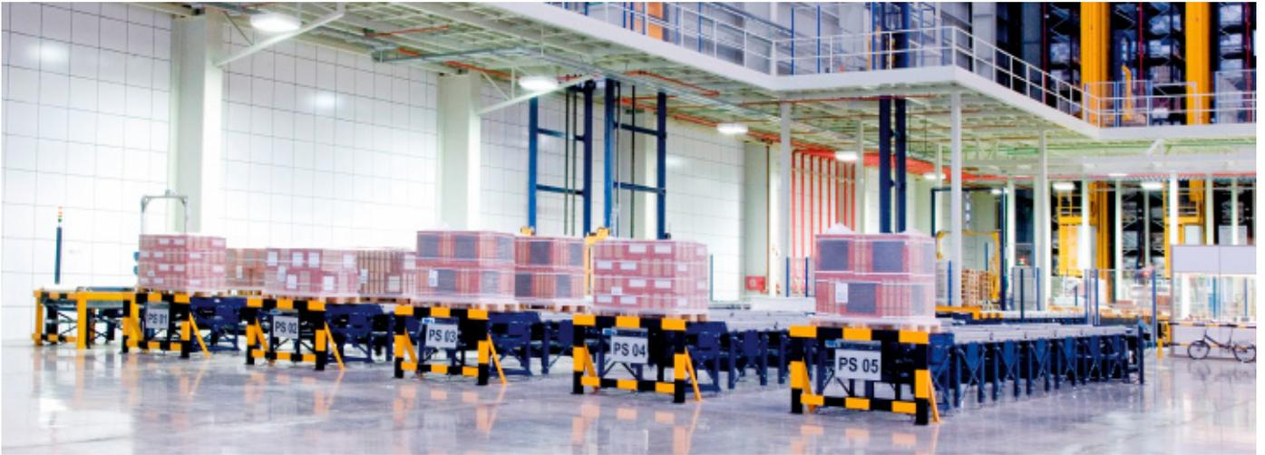
El sistema de precargas reagrupa los palets de un mismo pedido o ruta y agiliza la operación de carga en los camiones de distribución
