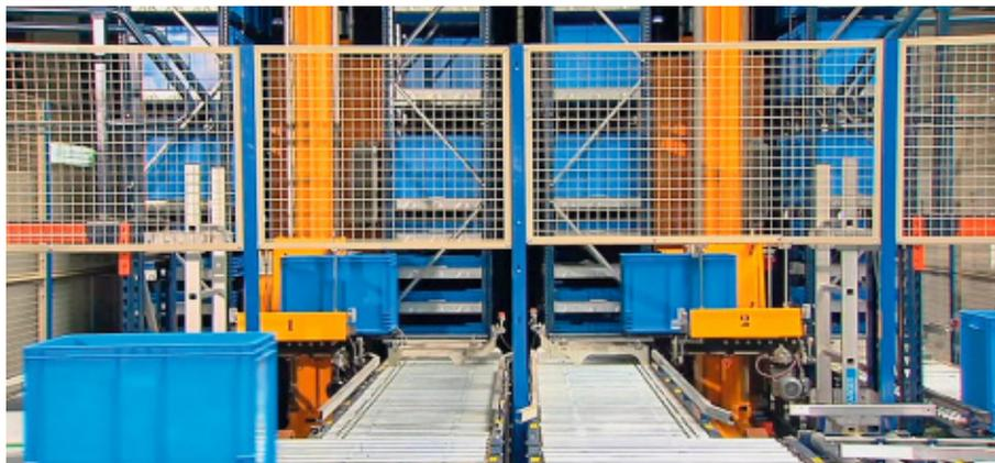
Por cada uno de los pasillos circula un transelevador cuya misión es la de efectuar la entrada y salida automática de la mercancía. En la parte frontal del almacén, se halla un circuito de transportadores que conecta los pasillos de almacenaje con dos puestos de picking y uno de reposición.
