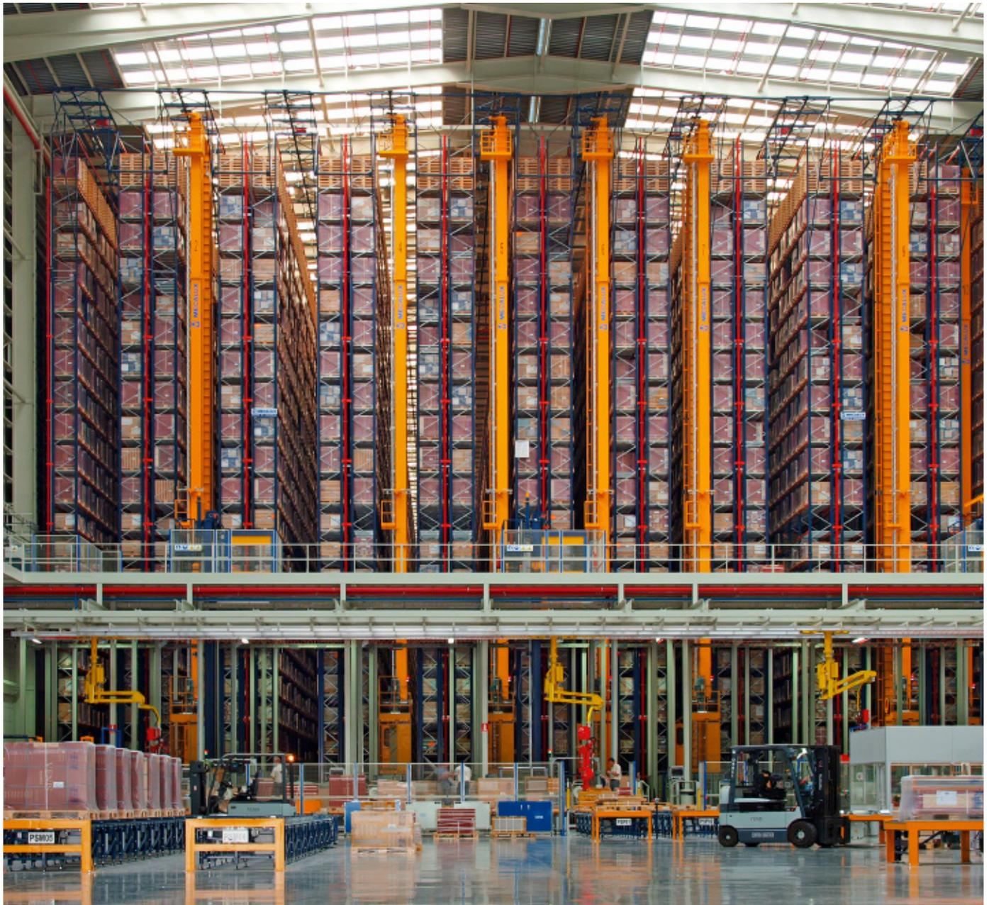
Los transelevadores, equipados con un regenerador de energía, son capaces de recuperar y devolver a la red eléctrica aproximadamente el 15% de la energía generada durante las maniobras de descenso de la cuna y deceleración del eje de traslación.
