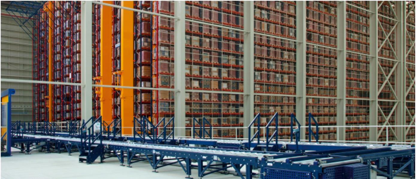
En la planta superior, se ha instalado el circuito de transportadores de entrada al almacén. Permite un reciclado para distribuir los palets con facilidad ante cualquier posible incidencia. Al mismo tiempo, comunica con el resto de elevadores que suben los palets procedentes del área de picking y de las entradas auxiliares.
