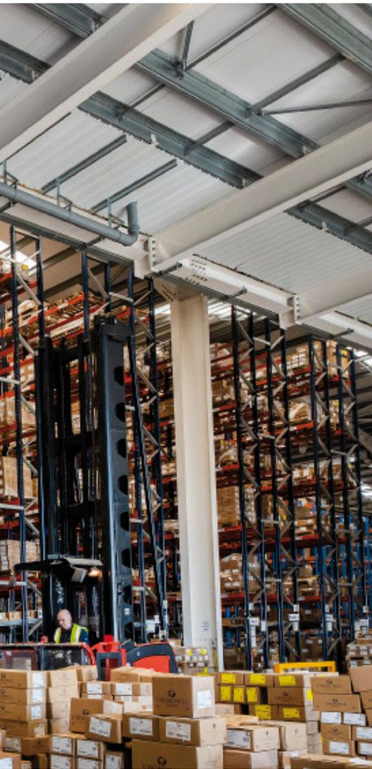
Una parte de los niveles inferiores son canales dinámicos. Allí se depositan dos palets, uno detrás de otro, y los operarios recogen las referencias que conforman cada pedido directamente del primer palet. Aquí se hace picking de los productos de mayor consumo porque, con este sistema, al disponer de los productos de reserva justo detrás, siempre hay mercancía disponible y se evita interrupciones en el servicio.
